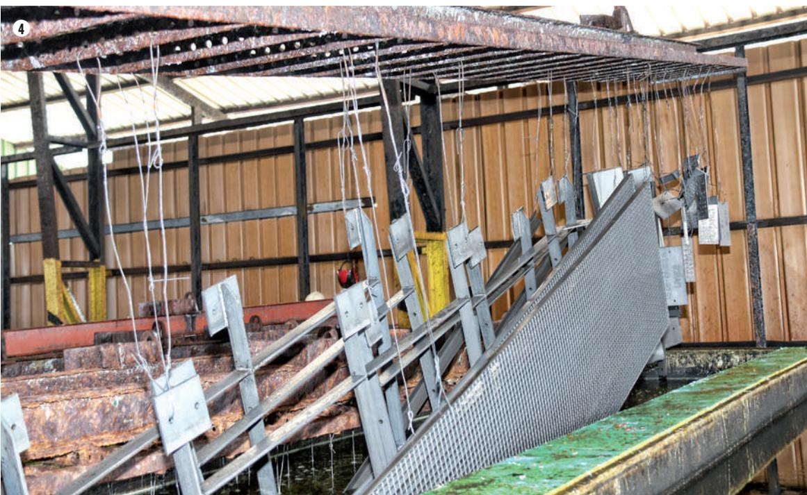
À leur arrivée, les pièces en acier sont déchargées, puis pesées. Une étiquette indiquant le nom du client, le numéro de commande, la date d'entrée sur le parc, sa date approximative de sortie et la description de l'ouvrage est alors imprimée et placée sur la commande 1.
